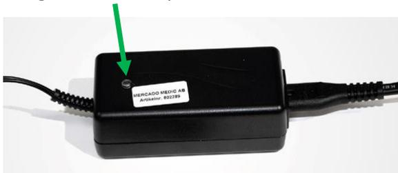
Wenn die grüne LED-Lampe dauerhaft leuchtet, ist die Batterie vollständig geladen. Der Ladevorgang dauert ca. sechs Stunden, unabhängig von der Batteriekapazität bei Ladebeginn.
